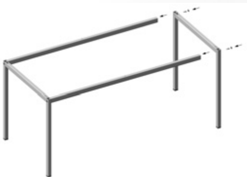
zerlegte Ausführung: 2 Seitenteile (N-Wangen) mit 2 Traversen und Verbindungsschrauben disassembled version: 2 side parts (N-leg) with 2 crossbars and connecting screws
