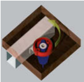
Bohrung für Plattenbuchse drilled hole for connector socket
